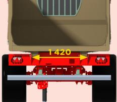
**Articulation de bennage placée au maximum à l'arrière** pour être le plus haut possible au bennage.
